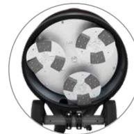
Gleichmäßiges Schleifresultat dank Planetenantriebssystem
