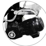
Das Antriebsgerät ermöglicht einen gleichmäßigen Vorschub
