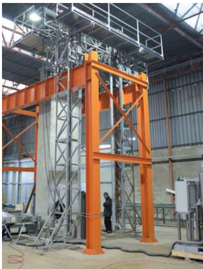
Große, stationäre Seilsägen für die Nuklearindustrie, entwickelt von Studio Corvi.
