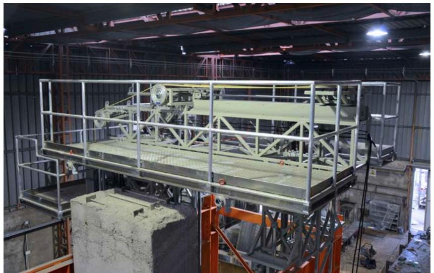
Große, stationäre Seilsägen für die Nuklearindustrie, entwickelt von Studio Corvi.
