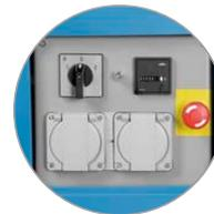
Drehrichtungsschalter, Sekundäranschlüsse, Stundenzähler
