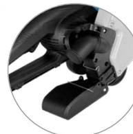
Eingebauter Staubsaugeranschluss für staubfreies bzw. sauberes Arbeiten
