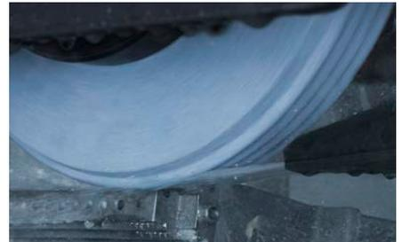
**+ Verkürzte Schleifzeit:** Die verbesserten Eigenschaften des Bindungssystems der STRATO ULTRA erhöhen die Zerspanungsleistung im Vergleich zu bisher marktgängigen Schleifscheiben signifikant.
