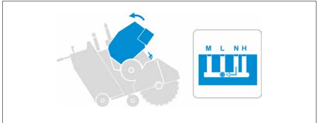
Changement de vitesse sur la boîte de vitesses à 3 rapports (schéma)
