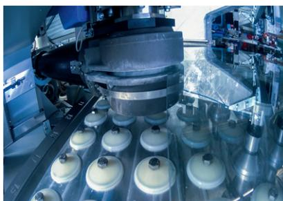
**Herramientas de diamante para el desbaste de vidrio en la industria de la automoción:** Fuimos la primera empresa productora de herramientas de diamante para el desbaste de vidrio de automoción a 40 m/min e impusimos un concepto que cambió la industria en el rectificado de cantos.
