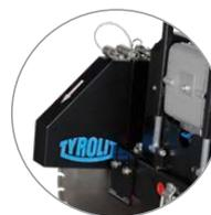
Un moteur monté dans le sens longitudinal avec renvoi d'angle pour une transmission maximale de puissance
