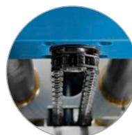
Sistema di guida a 2 colonne con trasmissione a catena
