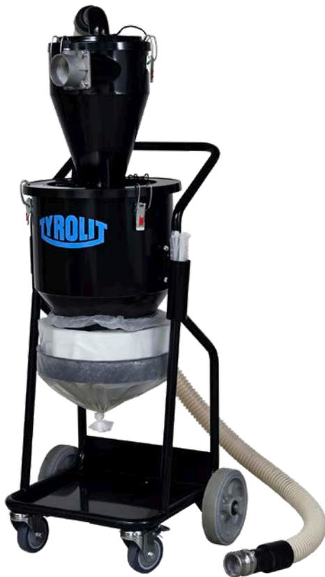
Der Vorabscheider VPM600UC wird besonders für die Staubsauger VCE2400D und VCE3600D empfohlen. Der Vorabscheider ist aber auch für andere Anwendungen in Verbindung mit Absaugsystemen geeignet, da er für Nass- und Trockenanwendungen eingesetzt werden kann und bis zu 90 % des abgesaugten
