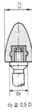
montaggio di una mola a ogiva con gambo, forma 16, con filettatura riportata
