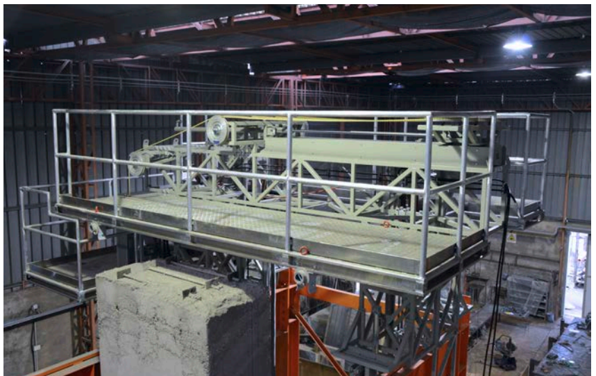
Grandes cortadoras de hilo estacionarias para la industria nuclear, desarrolladas por Studio Corvi.
