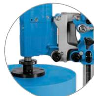
Perforaciones con diámetro de hasta 500 mm con placas distanciadoras ModulDrill™
