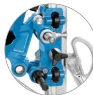
Sistema de sujeción rápida ModulDrill™: fijación rápida, sencilla y segura del motor de perforación
