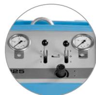
Indicadores de manómetro para circuito principal y circuito de desplazamiento
