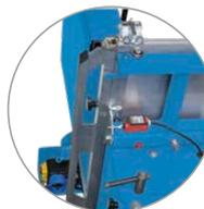
Desconexión automática de la sierra de cinta: no se produce ningún esfuerzo innecesario de la sierra, pues esta sólo funciona cuando se está realmente cortando.
