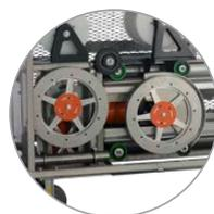
Óptimo par de arranque y transmisión de fuerza de bajo deslizamiento gracias a las dos grandes ruedas motrices.
