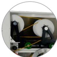
Carga reducida en los componentes principales debido al almacenador del hilo de diamante sin tensión.
