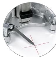
Allineamento del supporto di carotaggio molto efficiente, con l'ausilio dell'indicatore del centro di serie
