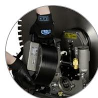
Fissaggio del motore senza attrezzi
