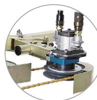
Motore idraulico di azionamento standard
