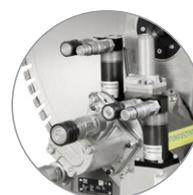
Testa di taglio robusta con motori idraulici standard
