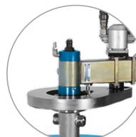
Les Bras à réducteur permettent le carottage jusqu'au diamètre 1 000 mm
