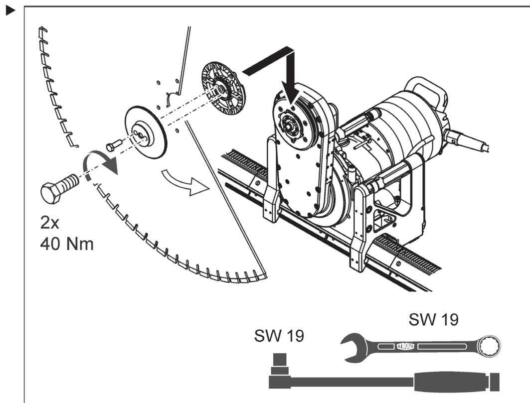
**3.4.4 Fissaggio per taglio normale con dischi di sega superiori a  $\varnothing$  1.000 mm**
